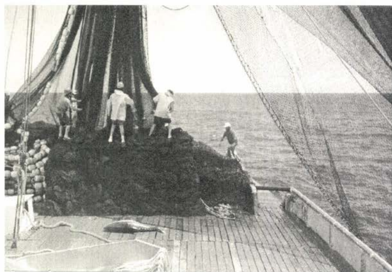
Figura 5 Maniobra de captura de atún en barco de red de cerco
