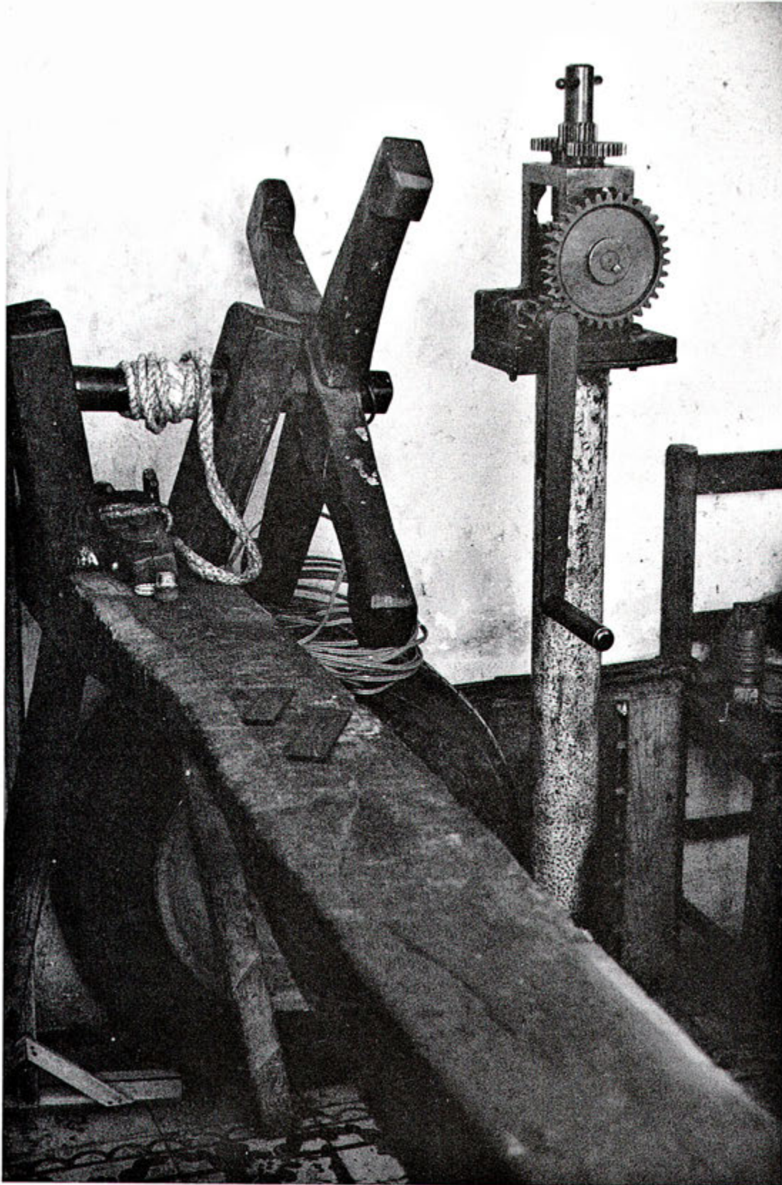
El torno sólo sirve a los plateros que usan mucho bilo, en cambio el laminador es útil para todos. (Foto: Abril Esquivel)
