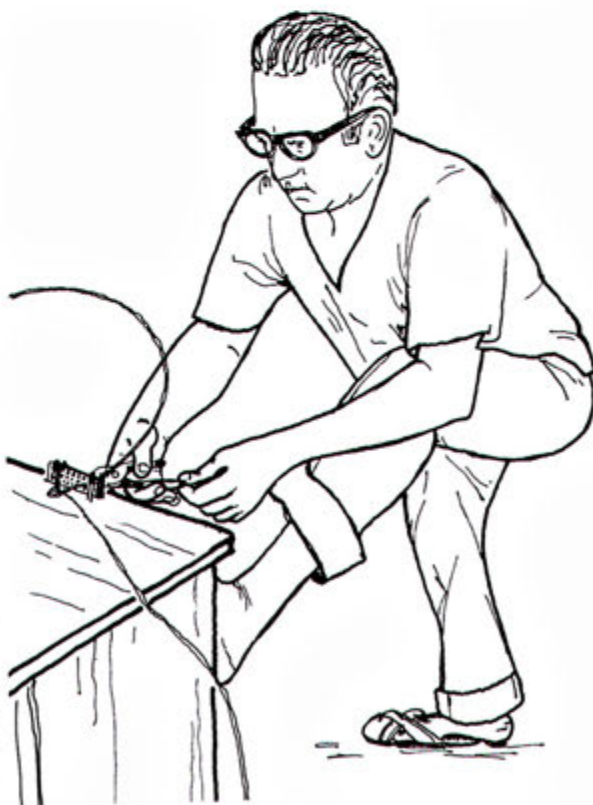
El platero utiliza diversas hileras para adelgazar el hilo de oro o plata.
