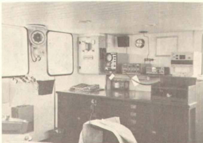
Barco "Escama XIII", sala de instrumentos (brújula, radiouniometro, clinometro, radiotransmisores, navegador Omega)
